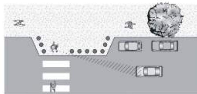
Une avancée de trottoir sur 10 m avant le passage (dans le sens d'où vient la circulation) et protégée du stationnement par des potelets augmente la visibilité du piéton par le conducteur (fig. 5.116.3-1).
